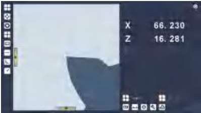
快速检查刀刃几何形状
