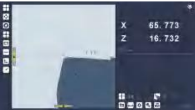
动态十字线会随X和Z轴移动而进行自动调整, 通过动态十字线快速测量刀具
